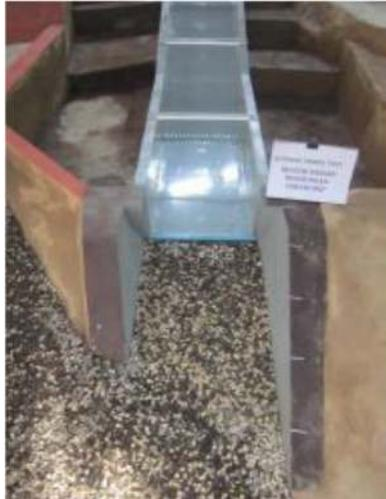
**Gambar 9. Kondisi peredam energi di model fisik hidraulik**
