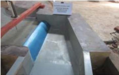
**Gambar 6. Kondisi pelimpah di model fisik hidraulik**
