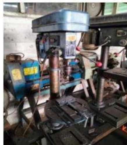
Gambar 2.10 Mesin Drilling Profesional 2JQ4116
