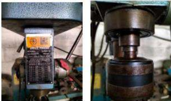
Gambar 2.11 Data Spesifikasi Mesin Drilling Profesional 2JQ4116 dan Posisi Bantalan/Drilling
