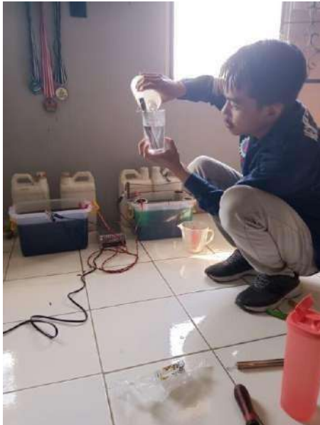
Gambar 1.1 Pemeriksaan Larutan elektrolit asam kromat
