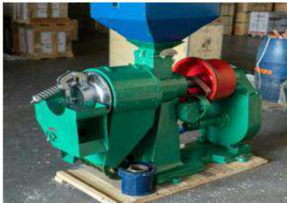
Gambar 2. 1 Mesin Penggiling Padi RICHI N50
