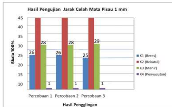
Gambar 4.6 Grafik Pengujian Jarak Mata Pisau 1 mm
