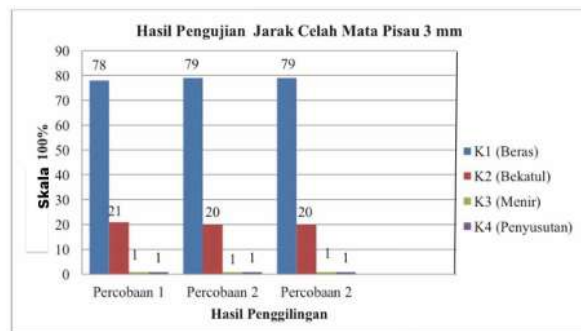
Gambar 4.14 Grafik Pengujian Jarak Mata Pisau 3 mm
