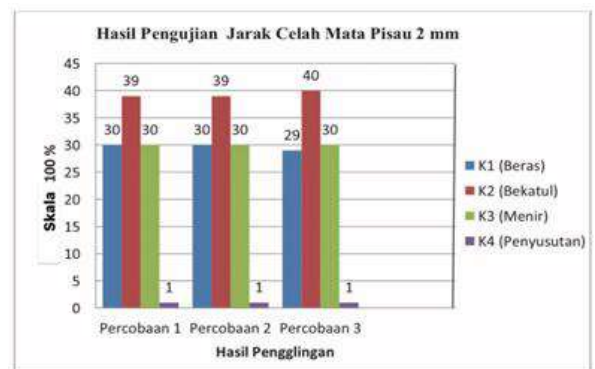
Gambar 4.10 Grafik Pengujian Jarak Mata Pisau 2 mm
