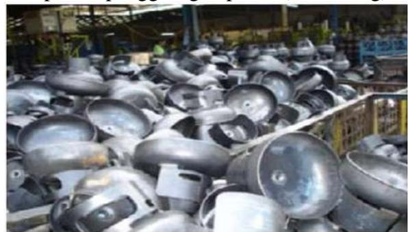
Gambar 2.7 Pelat Baja SG 295 yang Telah Dibentuk Setengah Tabung
