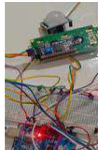
Gambar 4. 29. Perakitan PIR sensor
