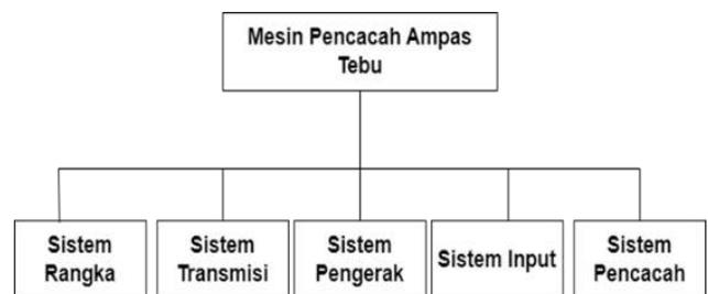
**Gambar 2.1.** Bagian-bagian alat pemotong
