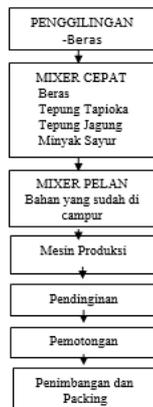
Gambar 1 : Diagram Alir Proses Produksi
