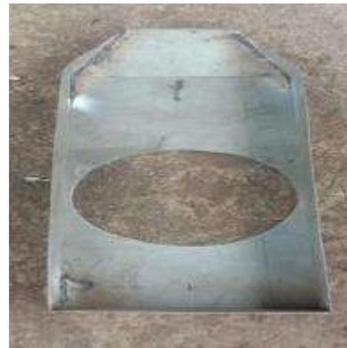
Gambar 4.1 gambar kerangka weeder Dalam gambar kerangka weeder ini ada lubang bagian bawah untuk pisau yang akan di pakai, dan lebar dudukan pisau tersebut 22 cm harus lebih besar dari pada piring pisau nya, supaya tidak ber benturan dengan pisau tersebut.
