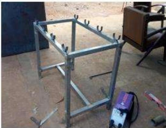
Gambar 3.4.7.1 Pembuatan Rangka Hidroponik
