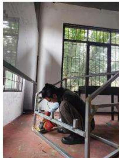
Gambar 3. 6 Proses penghalusan rangka
