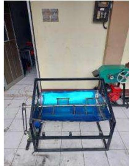
**Gambar 3. 9 Gambar Hasil akhir pembuatan mesin pencuci beras**
