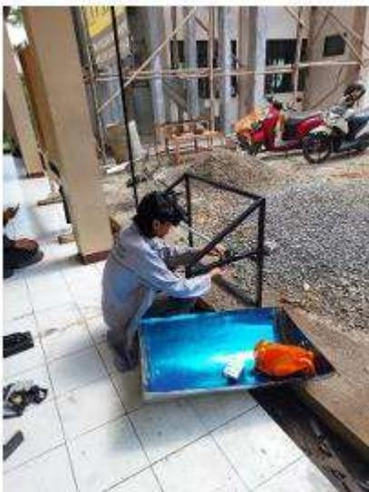
**Gambar 3. 8 Proses perakitan mesin pencuci beras**
