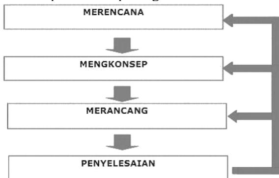
Gambar 1 Diagram Alir Perancangan Metode VDI 2222 (Harsokoesoemo, 2004)
