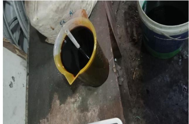
Gambar 4.2.5 merupakan gambar pengukuran cairan crome dengan menggunakan baume meter
