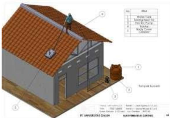
Gambar 3.7 Cara Pengoperasian Mesin Pembersih Genteng
