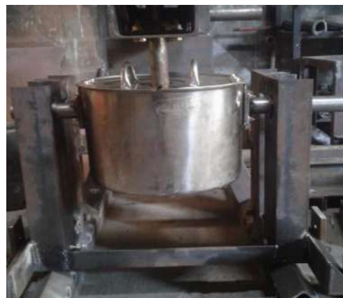
Gambar 4.11 Hasil Dari Pembuatan Tungku
