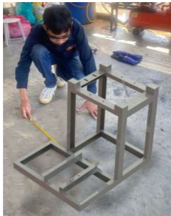
Gambar 4.5 Hasil penyambungan profil Pengelasan Rangka
