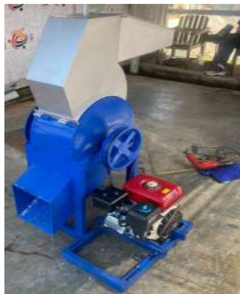
Gambar 4.7 Mesin Pencacah Plastik dengan Pisau Scratch
