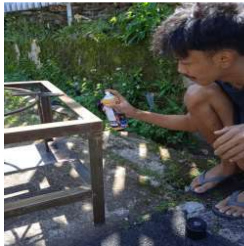
Gambar 4. 19 Proses Pengecatan menggunakan Pylox
