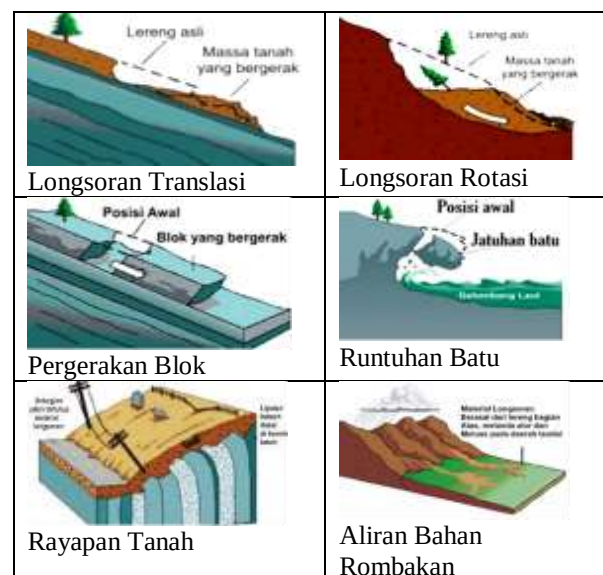
Gambar 1. Pergerakan Lereng Berdasarkan Klasifikasi oleh Varnes (1978) dan Cruden dan Varnes (1996).
