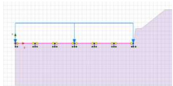
Gambar 10. Pemodelan Struktur Kolam Lindi dengan Fondasi Footplate
