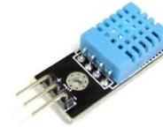
Gambar 2. Modul DHT11
