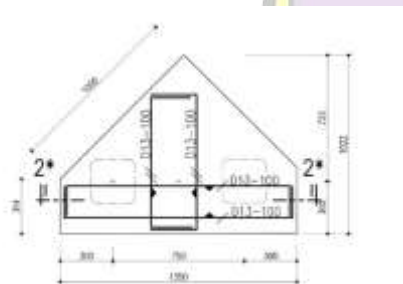
Gambar 4. Susunan Pondasi Kelompok 2 Tiang
