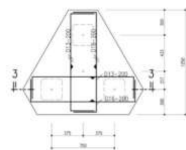
Gambar 5. Susunan Pondasi Kelompok 3 Tiang
