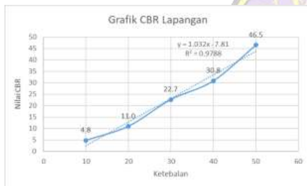
Gambar 17 Grafik hasil Pengujian CBR Lapangan
